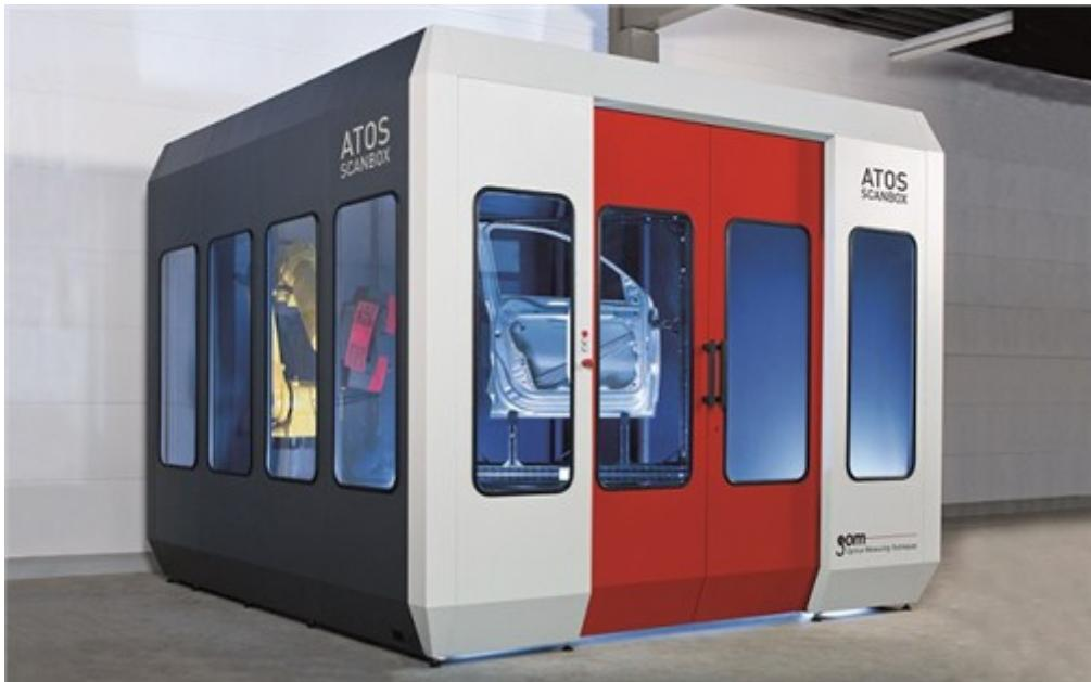
三维测量，顾名思义就是被测物进行全角度测量，确定被测物的三维坐标测量数据。其测量原理分为测距、角位移、扫描、定向四个方面。根据三维技术原理研发的仪器包括拍照式（结构光）三维扫描仪、激光三维扫描仪和三坐标测量机三种测量仪器。三维测量可定义为“一种具有可作三个方向移动的探测器，可在三个相互垂直的导轨上移动，此探测器以接触或非接触等方式传送讯号，三个轴的位移测量系统经数据处理器或计算机等计算出工件的各点坐标(X·Y·Z)及各项功能的测量”。三维测量的测量功能应包括尺寸精度、定位精度、几何精度及轮廓精度等。
