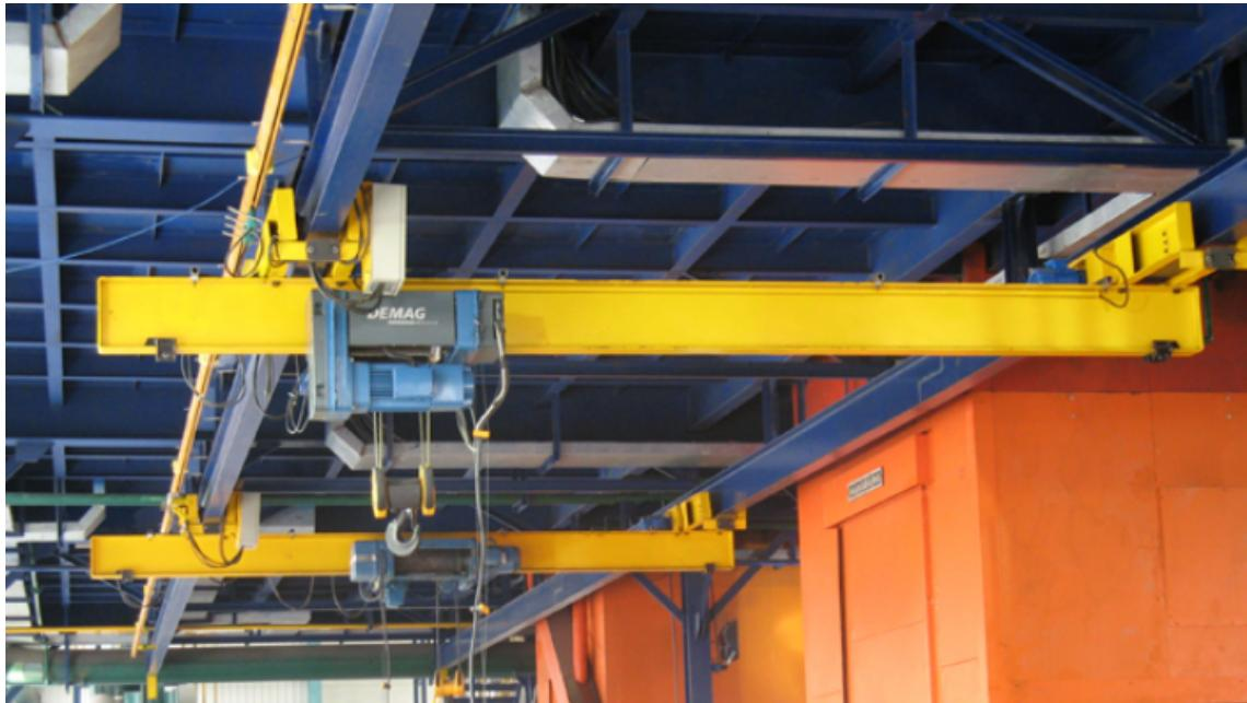
悬挂起重机，分为单梁悬挂起重机，双梁悬挂起重机等。一、产品特点：1. 起升、小车、大车三机构控制，能单独或同时运行；2. 运行小车于横梁间采用铰接结构链接；3. 所有连接采用快插式重型航空插头插座，密封好，接插牢固，便于维护；4. 移动供电系统采用起重机PVC扁电缆，耐压等级达到450/750V 50Hz；5. 小车移动供电系统采用内置式电缆滑车、镀锌轨道和扁电缆等供电；6. 插头连接部位采用塑料套管绝缘保护；7. 控制方式，手电门，无线遥控，半自动控制，全自动控制等。二、安全可靠性：1. 上升及下降限位；2. 超载限制器；3. 大车及小车运行采用机械及电气双限位安全保护；控制部分，配置急停开关、短路保护、失压保护、相序保护等功能。
