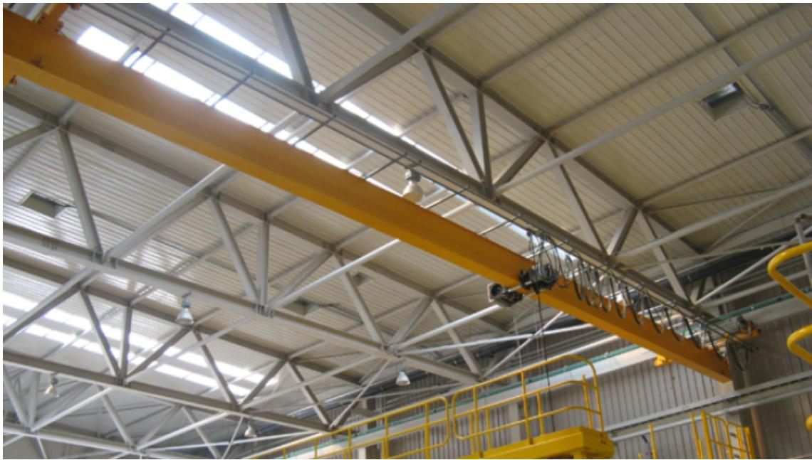
悬挂起重机，分为单梁悬挂起重机，双梁悬挂起重机等。一、产品特点：1. 起升、小车、大车三机构控制，能单独或同时运行；2. 运行小车于横梁间采用铰接结构链接；3. 所有连接采用快插式重型航空插头插座，密封好，接插牢固，便于维护；4. 移动供电系统采用起重机PVC扁电缆，耐压等级达到450/750V△5△ 小车移动供电系统采用内置式电缆滑车、镀锌轨道和扁电缆等供电；6. 插头连接部位采用塑料套管绝缘保护；7. 控制方式，手电门，无线遥控，半自动控制，全自动控制等。二、安全可靠性：1. 上升及下降限位；2. 超载限制器；3. 大车及小车运行采用机械及电气双限位安全保护；控制部分，配置急停开关、短路保护、失压保护、相序保护等功能。悬挂起重机，包括单梁悬挂起重机、双梁悬挂起重机，生产厂，南京高锐特。无锡悬挂起重机行情
