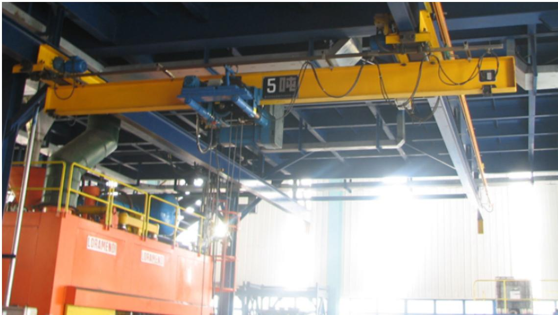
悬挂起重机，分为单梁悬挂起重机，双梁悬挂起重机等。一、产品组成：1. 悬挂起重机，主要由主梁、悬挂横梁装置、运行小车、电动葫芦或起升机构、限位装置及控制系统等组成。二、产品特点：1. 起升、小车、大车三机构控制，能单独或同时运行；2. 运行小车于横梁间采用铰接结构链接；3. 所有连接采用快插式重型航空插头插座，密封好，接插牢固，便于维护；4. 移动供电系统采用起重机PVC扁电缆，耐压等级达到450/750V 50Hz；5. 小车移动供电系统采用内置式电缆滑车、镀锌轨道和扁电缆等供电；6. 插头连接部位采用塑料套管绝缘保护；7. 控制方式，手电门，无线遥控，半自动控制，全自动控制等。三、安全可靠性：1. 上升及下降限位；2. 超载限制器；3. 大车及小车运行采用机械及电气双限位安全保护；4. 控制部分，配置急停开关、短路保护、失压保护、相序保护等功能。无锡悬挂起重机行情电动悬挂起重机，有单梁悬挂起重机、
